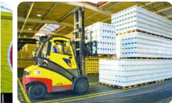
Die Gabel sieht alles: An den Staplern montierte Scanner ermöglichen die Dokumentation der Palettendaten.
