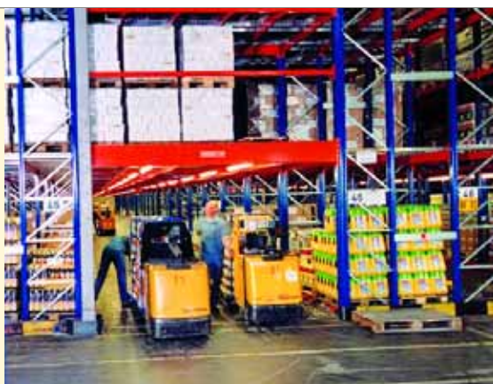
Raumgewinn: Kommissioniertunnel im umgerüsteten Edeka-Lager.
