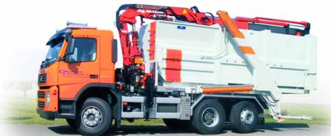
Ein TLC 165.2E von Atlas mit einem Absetzaufbau. (Fotos: Atlas Maschinen)
