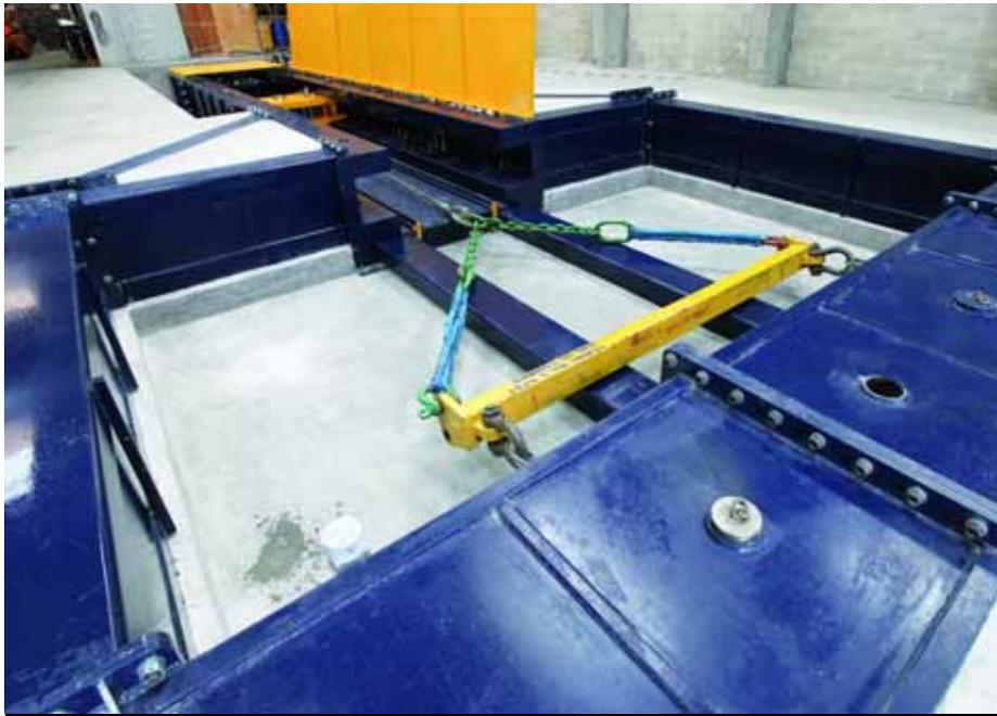
Die Kraft der zwei Zylinder: Die beiden hydraulischen Zugeinheiten ergeben auch im Hinblick auf kommende Entwicklungen eine Prüflast von immerhin 1200 t.
