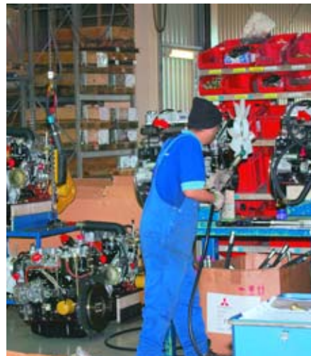
Die „Hochzeits“-Zone: Hier gründen Motor und Getriebe zusammen einen Antriebsstrang.
