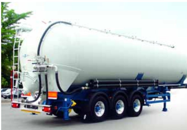
Der Spitzer-Silo-Sattelanhänger in Composite-Bauweise kann bis zu 300 kg mehr Ladung aufnehmen. (Foto: Spitzer)
