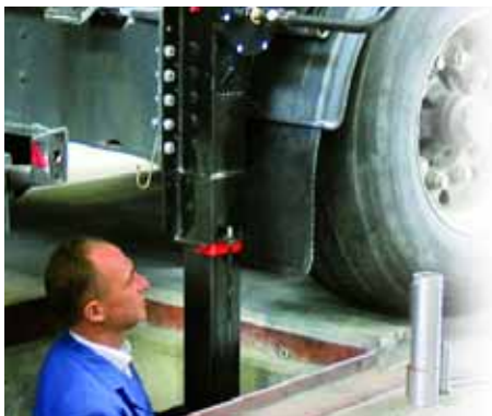
Das Entleeren von Kipp-Siloanhängern setzt hintere Abstützungen voraus.
