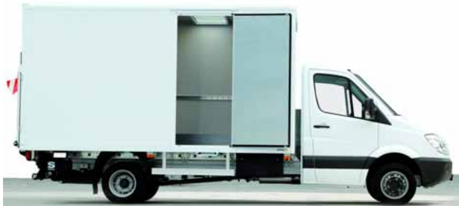
Leichter Koffer: Junge bietet verschiedene gewichtsoptimierte Kofferaufbauten für den Sprinter. (Foto: Junge)
