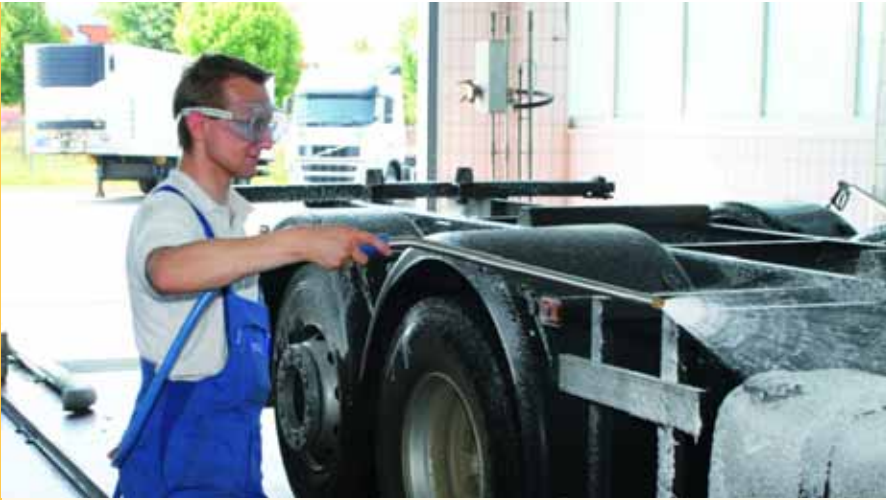
EINSEIFEN VON HAND: Neuralgische Stellen werden von Hand gereinigt.
