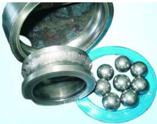
Der nicht optimale Schmierstoff konnte dieses hoch belastete Lager nach nur zwei Jahren Einsatz und rund 90.000 km Laufleistung nicht optimal vor Verschleiß schützen. (Foto: ZF)
