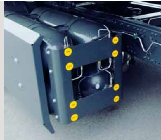
GAS FÜR EINE TAGESTOUR: Die Gastanks sind so bemessen, dass die Fahrzeuge einen Tag Lieferverkehr ohne Boxenstopp bewältigen können.
