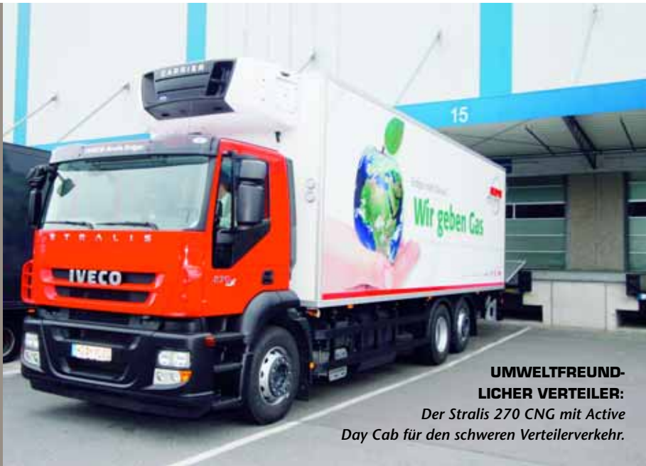
GAS FÜR EINE TAGESTOUR: Die Gastanks sind so bemessen, dass die Fahrzeuge einen Tag Lieferverkehr ohne Boxenstopp bewältigen können.
