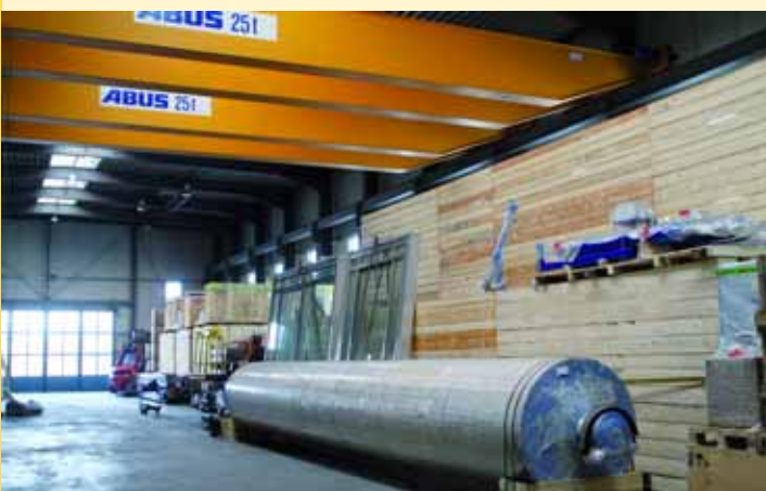
SCHWERLASTLAGER: Zwei 25-t-Hallenkrane stehen für den Umschlag zur Verfügung.
